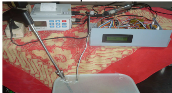
Gambar 3.4 Perangkat sensor gas CO yang digunakan untuk akuisisi data
