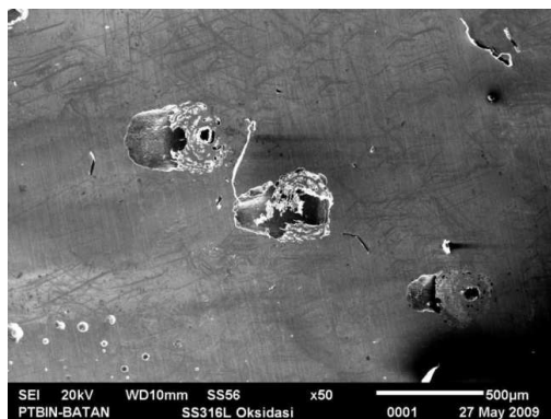
Gambar 3.7 Struktur mikro sampel yang tidak dinitridasi dan telah terkorosi.
